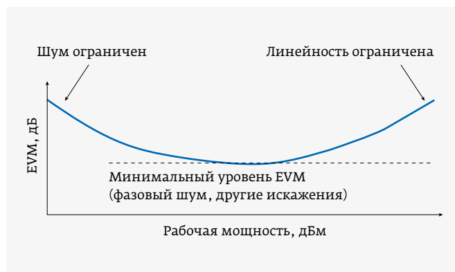
Рис. 4. U-образная кривая зависимости EVM от рабочей мощности
