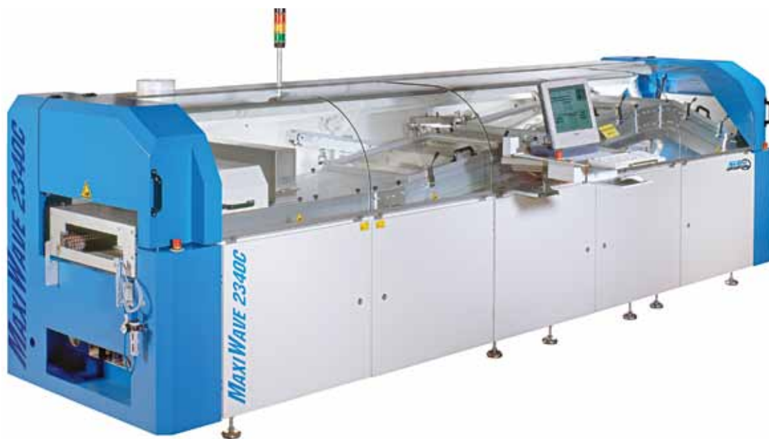
Рис. 4. Система групповой пайки волной MaxiWave 2340C от компании Seho
