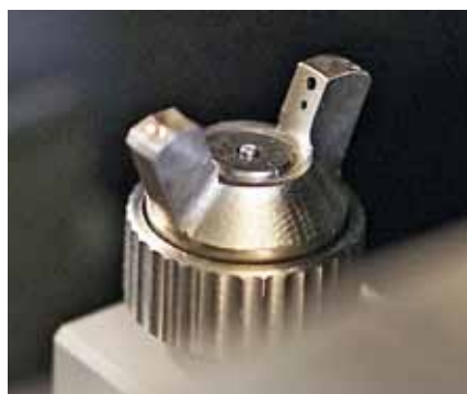
Рис. 9. Головка флюсователя спрей-типа
