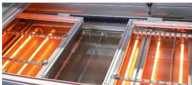
Рис. 5. Нагреватель типа Pulsar
