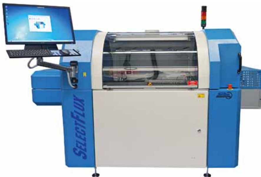
Рис. 10. Координатный флюсователь SelectFlux
