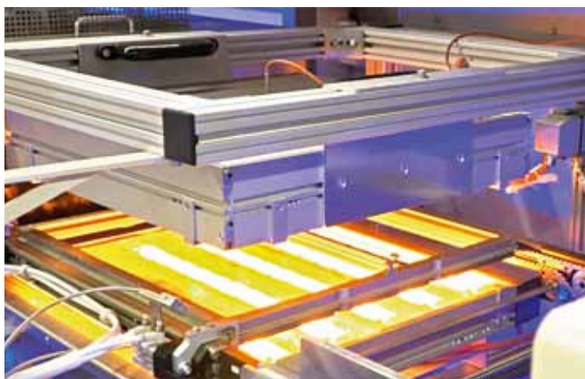
Рис. 2. Модуль предварительного нагрева печатной платы
