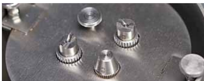
Рис. 11. Головка флюсователя серии SelectFlux
