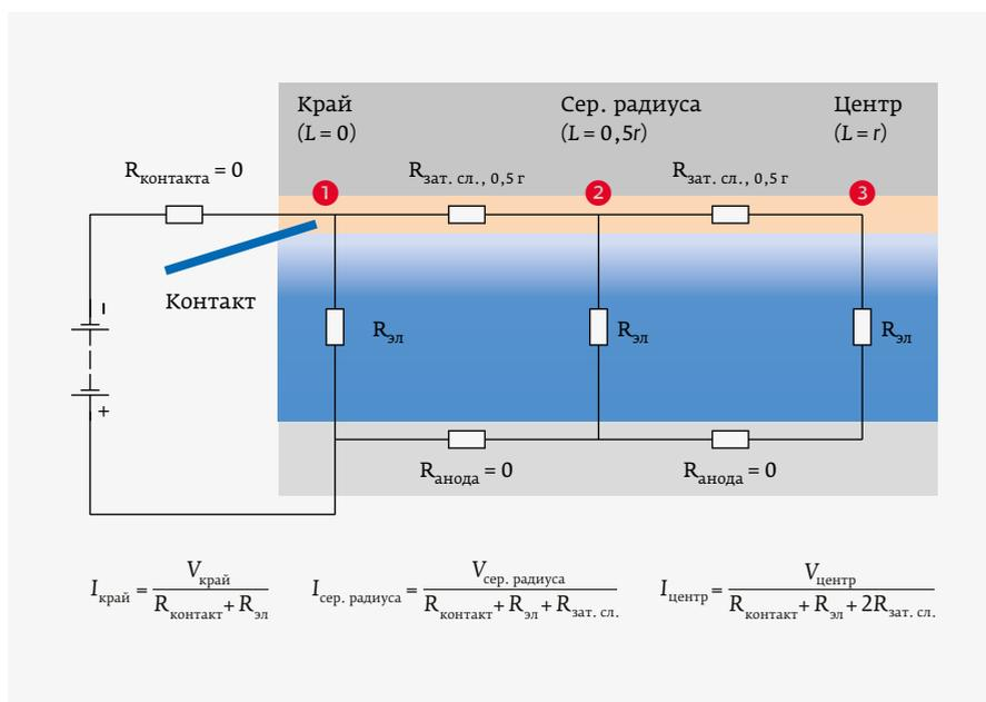
Рис. 4. Распределение тока через пластину
