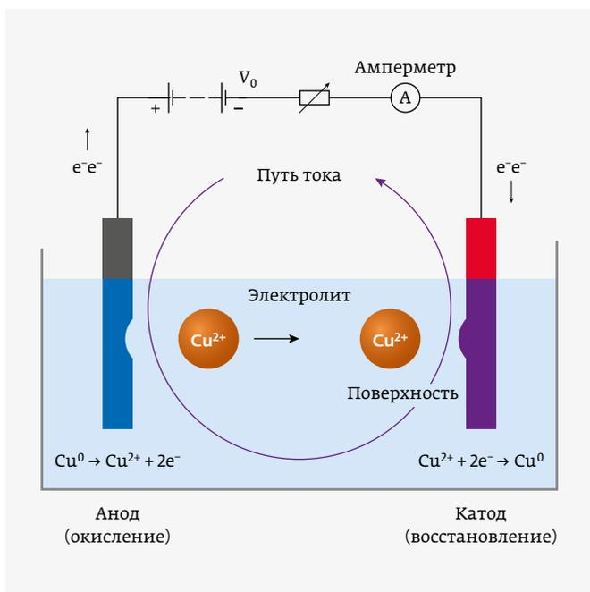
Рис. 1. Электролитическая ячейка
