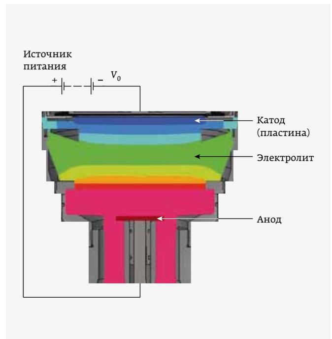
Рис. 6. Профиль электрического поля в современном реакторе системы ECD
