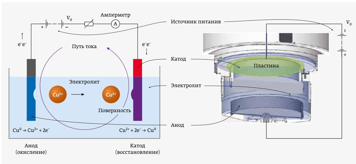
Рис. 2. Электролитическая ячейка (а) и реактор (б)
