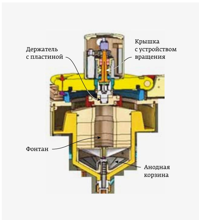
Рис. 5. Современный реактор
