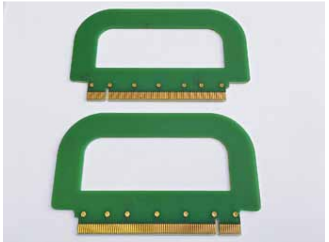
Рис. 5. Платы-заглушки для прозвонки межсоединений ПЛИС
