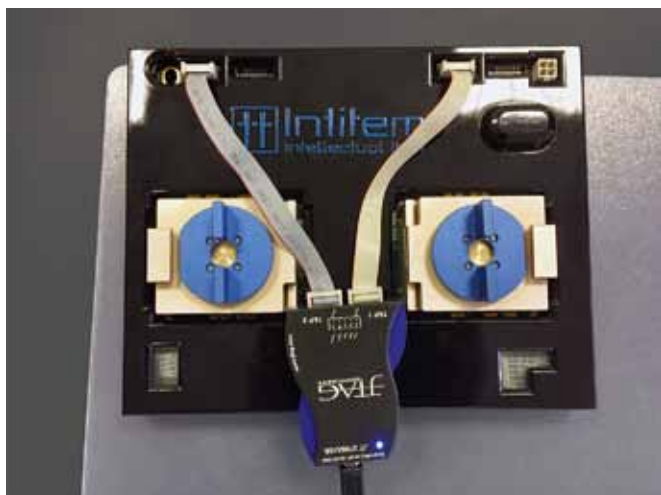
Рис. 8. Устройство EG-X7V1140-1930 компании «ИнжГрупп» для входного контроля микросхем XC7VX1140T-1FLG1930I
