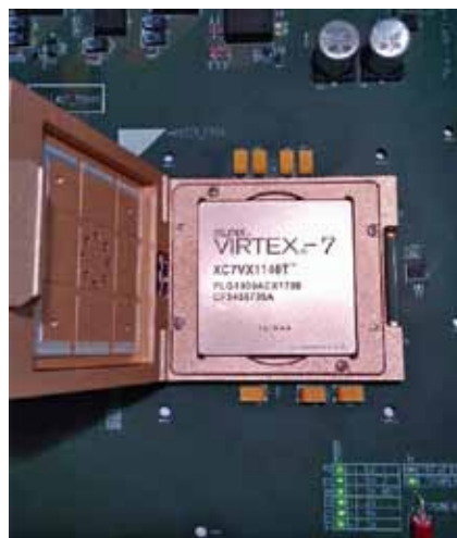
Рис. 7. Микросхема XC7VX1140T-1FLG1930I, установленная в КУ устройства EG-X7V1140-1930 без крышки
