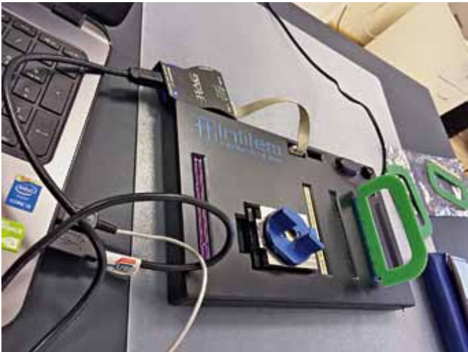
Рис. 4. Стенд компании «ИнжГрупп» для входного контроля микросхем Xilinx Virtex-7 XC7VX690T-1FFG11571
