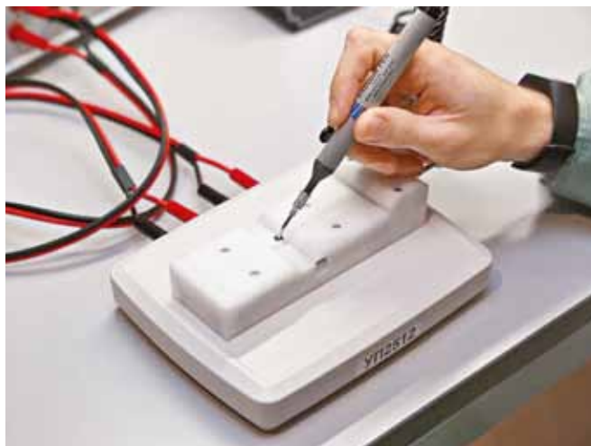
Рис. 1. Тестовая оснастка для входного контроля отдельных чип-резисторов производства компании «Остек-Электро»
