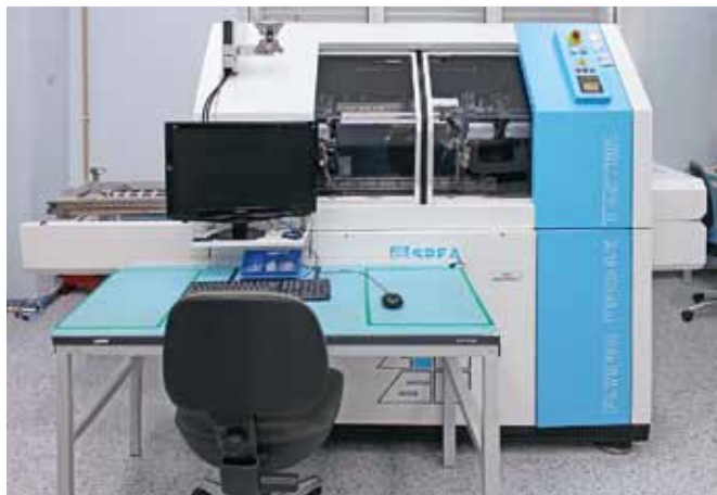
Рис. 2. Система входного контроля печатных плат SPEA 4060
