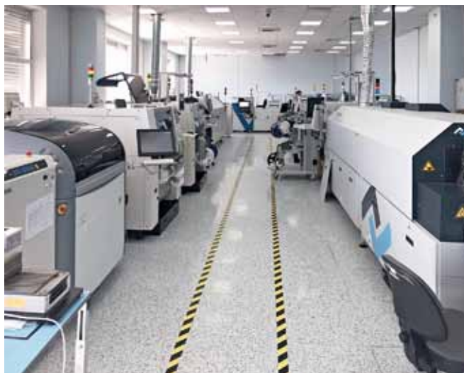
Рис. 1. Линия поверхностного монтажа печатных плат ООО «НПО ПКРВ»
