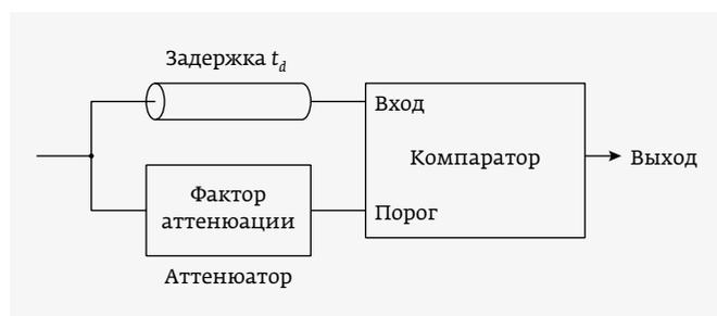
Рис. 5. Схема с плавающим порогом
