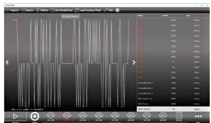
Рис. 5. Идеальный сигнал PAM3 100BASE-T1, созданный с помощью программы Waveform Editor Utility
