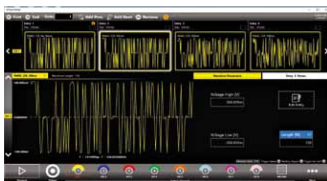
Рис. 7. Последовательность сигналов РАМЗ с возрастающим влиянием шума
