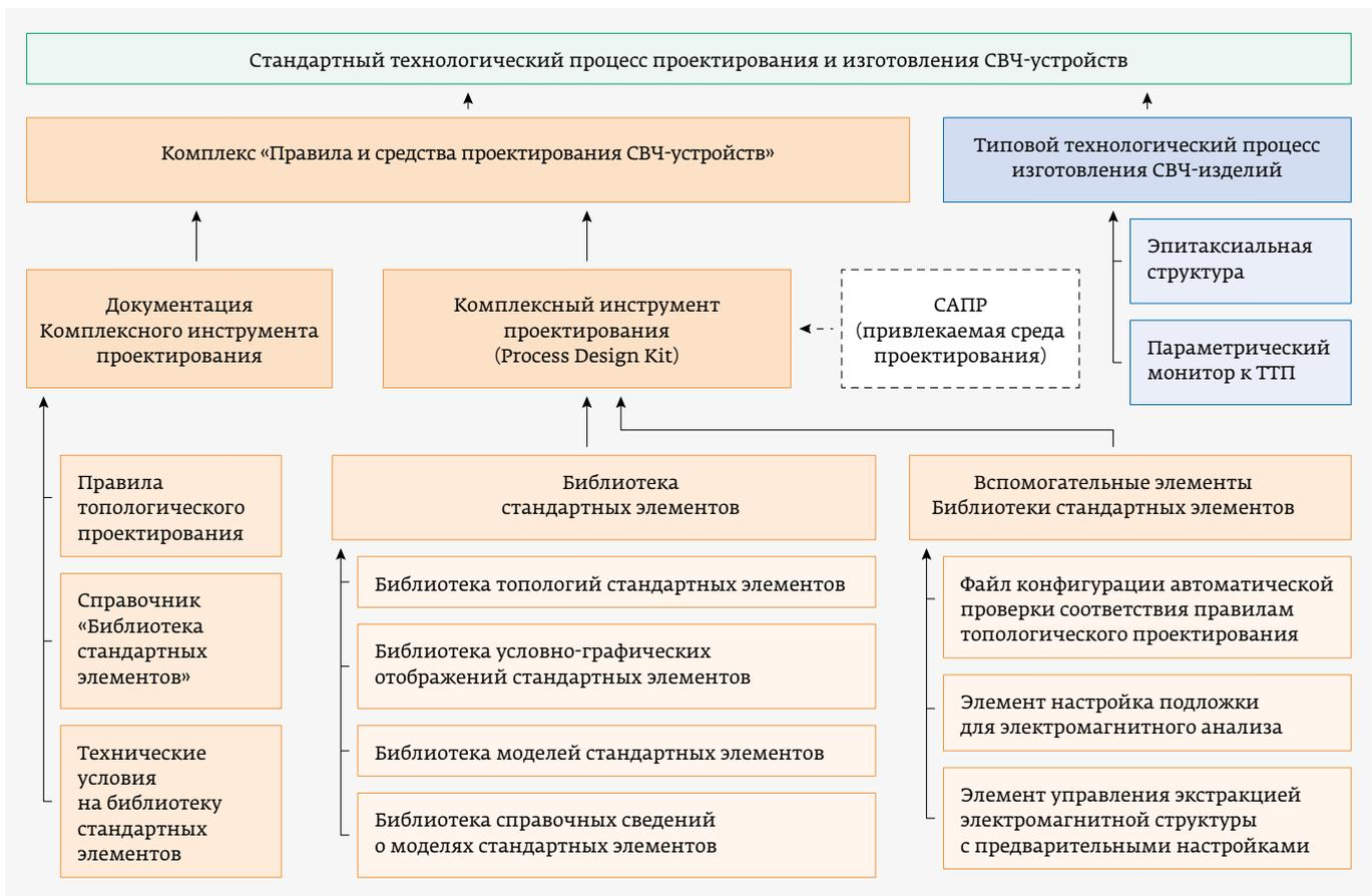
Рис. 1. Структурная схема стандартной технологии проектирования и производства СВЧ МИС
