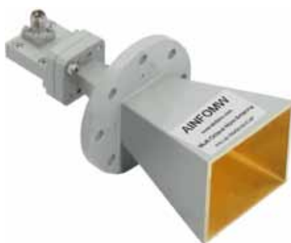
Рис. 9. Мультиоктавная рупорная антенна LB-180400-20 (диапазон 18-40 ГГц, коэффициент усиления 20 дБи)
