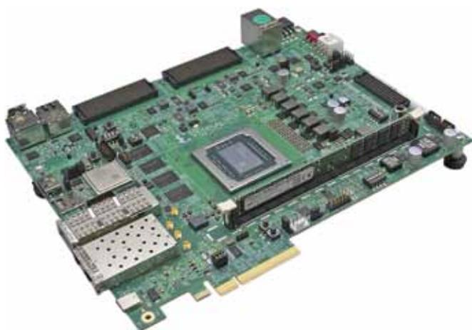
Рис. 4. Внешний вид отладочной платы Versal AI Core Series VCK190
