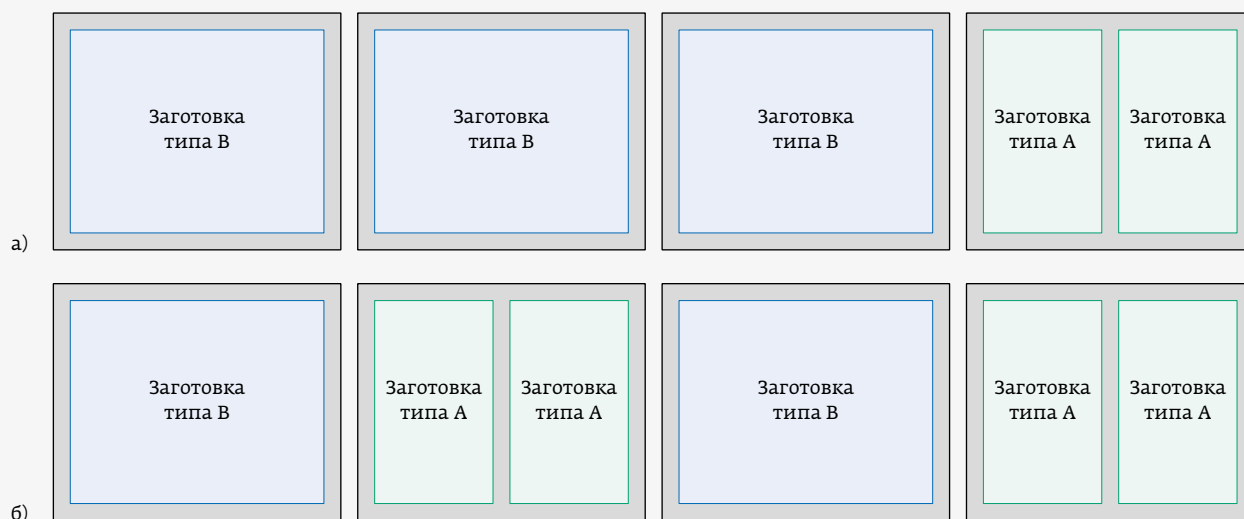
Рис. 28. Схема поступления рамок-носителей с платами в установку групповой пайки волной: а – исходная конфигурация; б – конфигурация после перегруппировки монтажников
