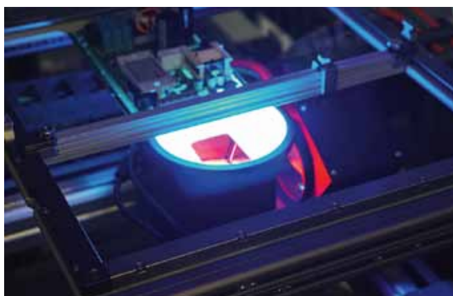
Рис. 23. Внутреннее пространство системы АОИ PowerVision
