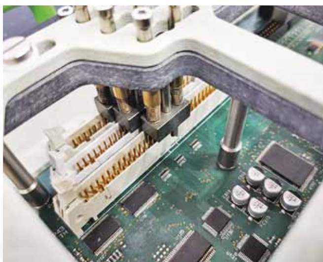
Рис. 25. Пример контроля правильности полярности разъема с помощью верхней крышки
