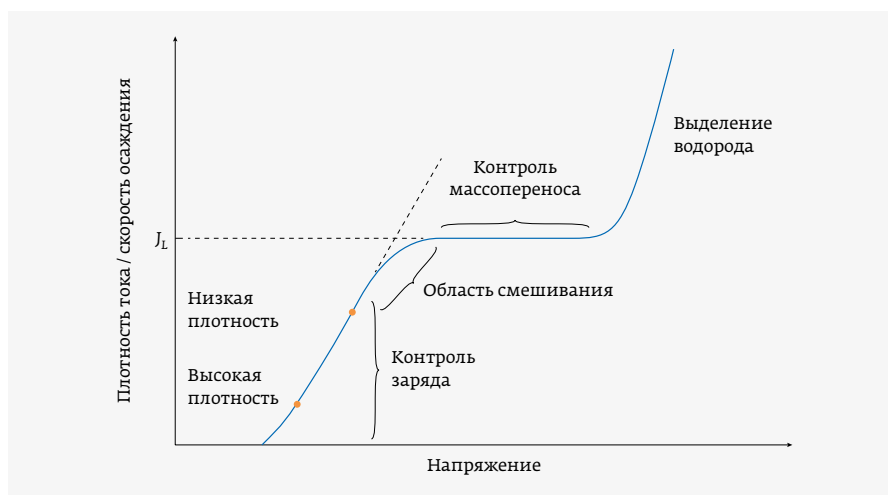
Рис. 9. Зависимость напряжения от плотности тока
