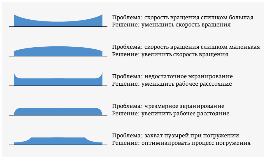
Рис. 12. Типичные профили сканирования диаметра
