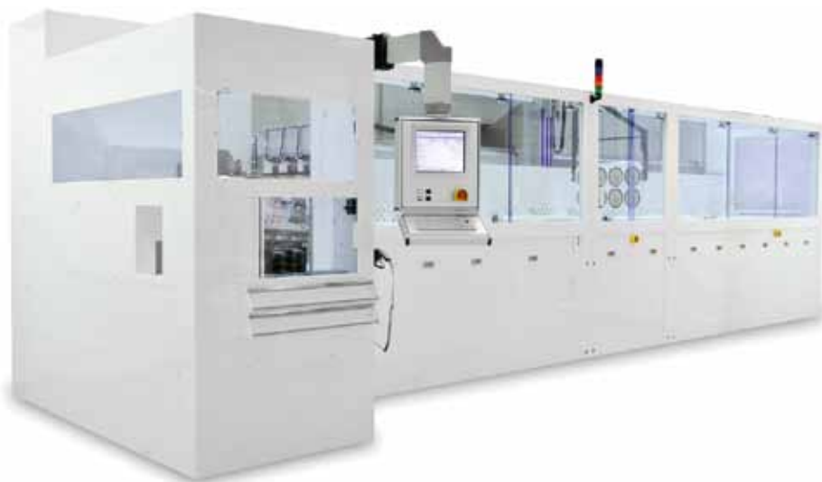
Рис. 14. Современная ECD-система для серийного производства RENA EPA
