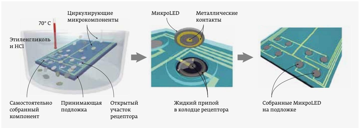
Рис. 6. Схема процесса флюидной самосборки
