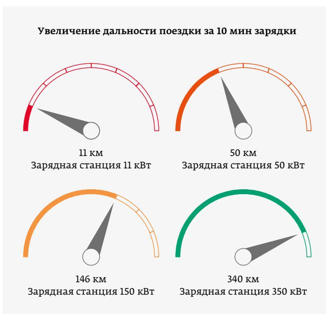
**Рис. 3.** Дальность поездки в зависимости от используемой зарядной станции
