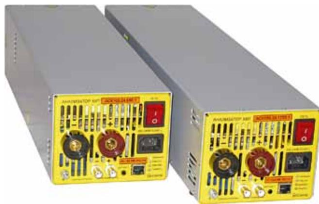
Анализаторы химических источников тока с рабочим напряжением от 1 до 28 В и током заряда и разряда до 100 и 150 А (до 2 и 3 кА при параллельном подключении)
