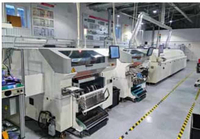
Установщики компонентов JUKI RS-1R в составе линии поверхностного монтажа
