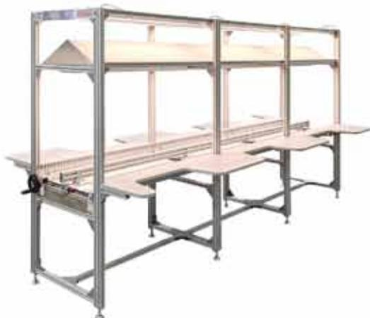
Конвейерные рабочие места СБК-3 и СБК-6 на три и шесть рабочих мест предназначены для организации последовательной работы монтажников в одной сборочной линии. Рабочие места располагаются в шахматном порядке, платы последовательно перемещаются от одного рабочего места к другому. Могут использоваться как на мелко-, так и на крупносерийном производстве.
