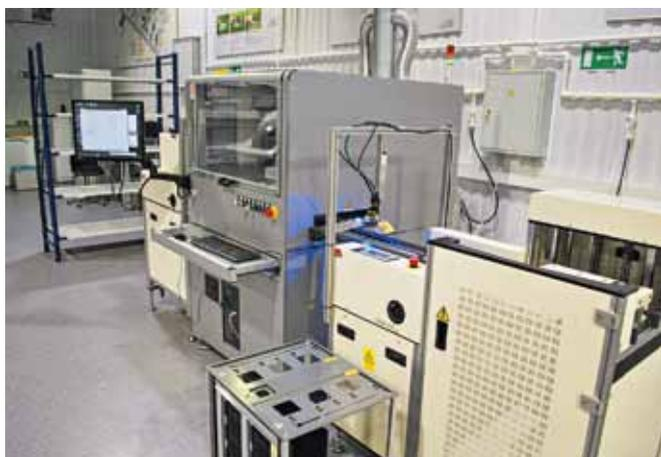
Установка лазерной маркировки KuboMark фирмы Mancini Enterprise (Италия)
