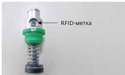
Наконечник установочной головки автомата JUKI RS-1R
