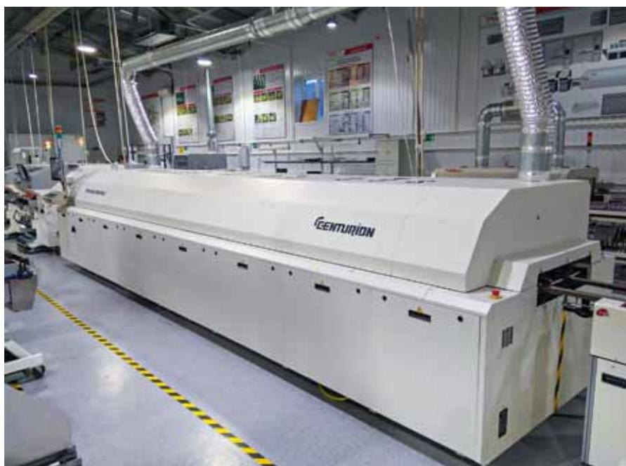
Конвекционная конвейерная печь Centurion CT-1040
