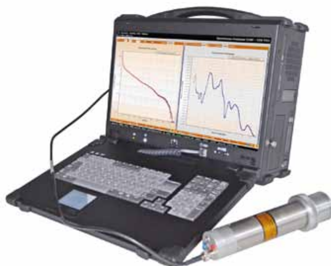
Рис. 1. Внешний вид спектрометра-дозиметра SDMF-1608SN с детектором быстрых нейтронов и гамма-квантов
