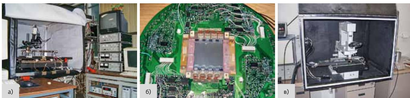
Рис. 10. АПК для проверки СЭ с микрополосковыми детекторами: а – АПК с лазером; б – плата СЭ треккера СВД-2, устанавливаемая на лазерном стенде; в – АПК с альфа- и бета-источниками
