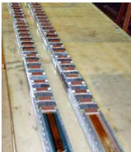
Рис. 20. Керамические гибридные платы детекторов с ЗЧУ
