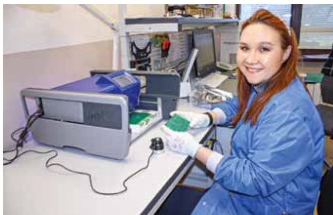
Рис. 4. Маркировка печатных плат
