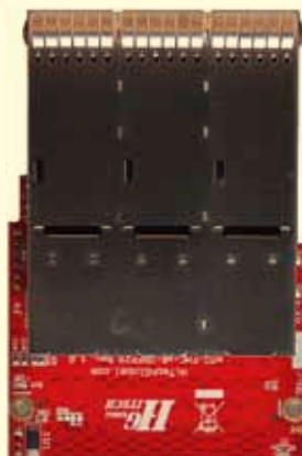
Рис. 2. Модули Vita 57.4 6-port QSFP28 / QSFP+ FMC+ Module
