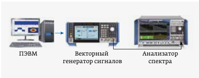
Рис. 3. Схема измерений параметров частотно-модулированного сигнала
