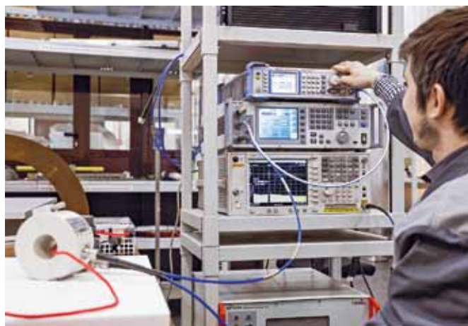
Рис. 2. Испытания на воздействие кондуктивных помех
