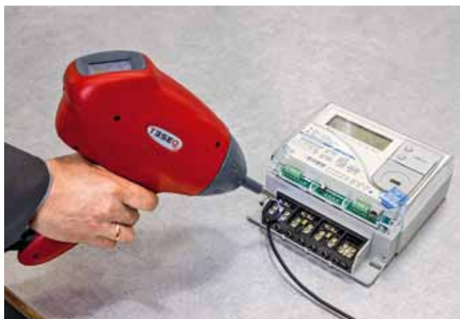
Рис. 3. Испытания на воздействие электростатических разрядов (воздушный разряд)
