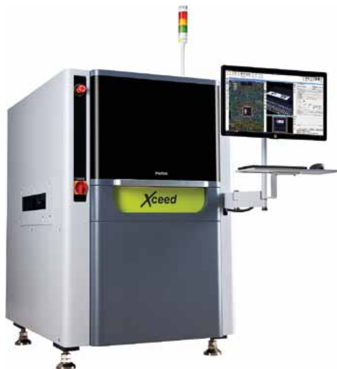
Рис. 1. 3D-система АОИ Xseed компании PARMi
