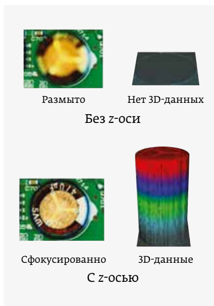
Рис. 6. Регулировка фокусного расстояния по оси Z позволяет получить четкое изображение компонентов
