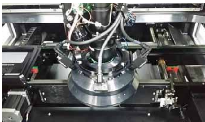
Рис. 7. Боковые камеры 360°-обзора в 3D-системе АОИ Xseed
