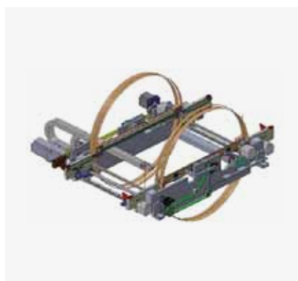
Рис. 8. Переворачивающий стол для двухсторонней инспекции
