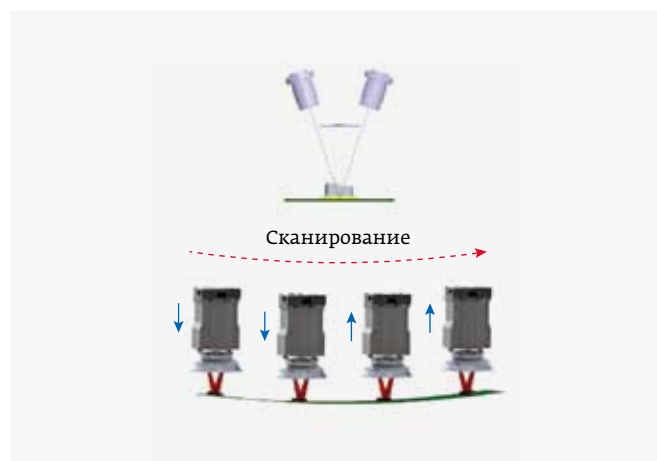
Рис. 4. Лазерное сканирование позволяет отслеживать прогиб образца в реальном времени
