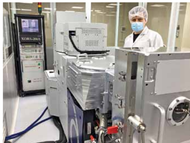
Рис. 1. Кластерная система XORS-200A с вакуумным перегрузчиком на три процессных модуля, лазерным ориентатором пластин и кассетным шлюзовым отсеком с элеватором
