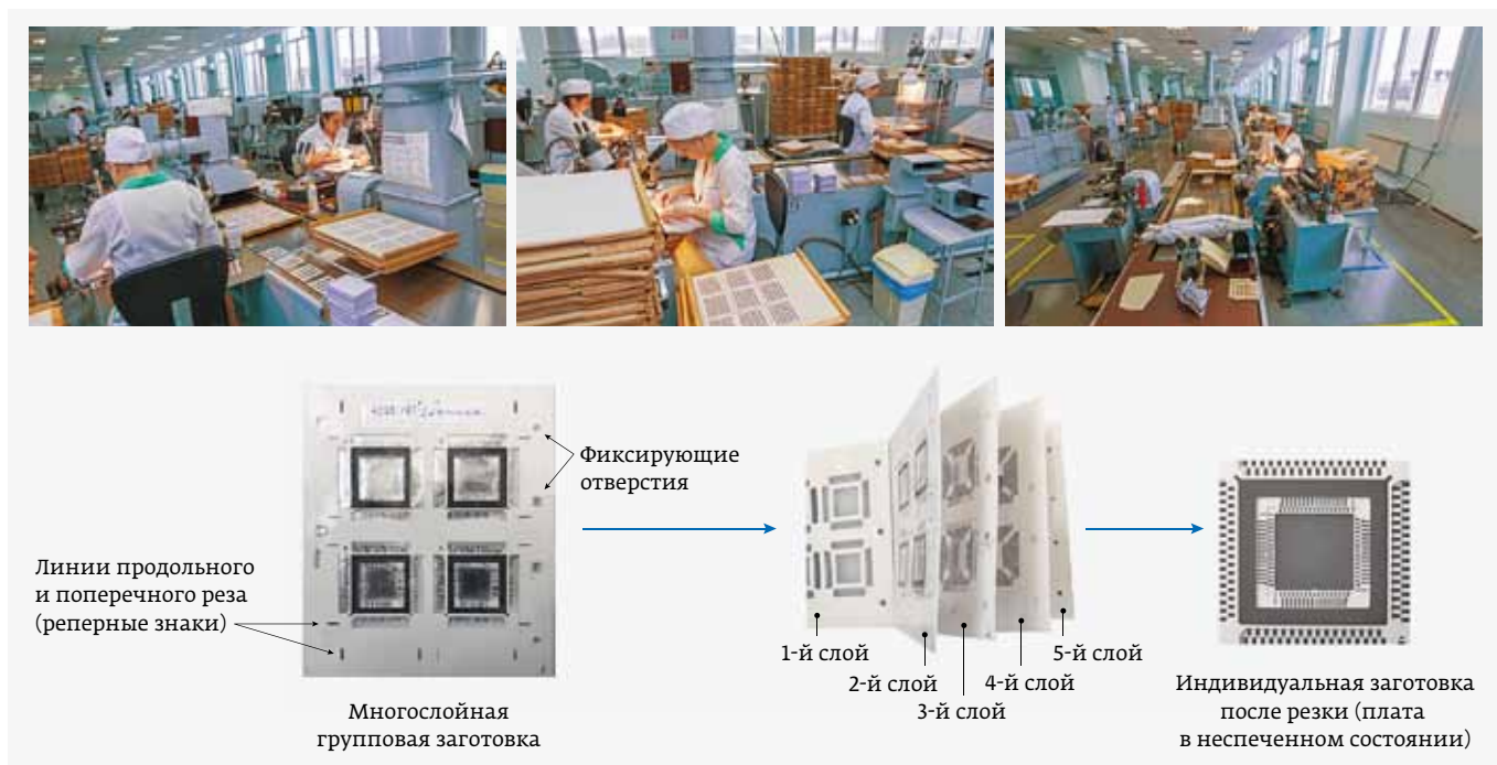
Рис. 5. Формирование металлокерамических плат в «сыром» (неспеченном) виде
