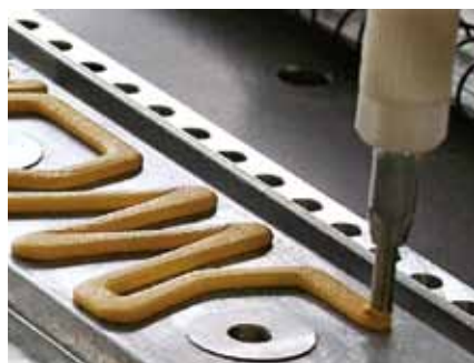
Рис. 2. Материалы GAP FILLER легко наносить с помощью дозаторов
