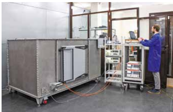
Рис. 3. Рабочее место на основе реверберационной камеры испытательной лаборатории ЭМС АО «ТЕСТПРИБОР»
