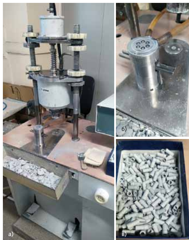
Рис. 2. Изготовление заготовок трубчатых конденсаторов: а – установка для горячего литья под давлением; б – литьевая форма; в – заготовки керамических корпусов фильтров Б14
