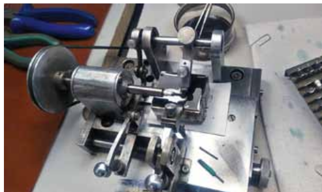
Рис. 3. Установка для серебрения трубчатых конденсаторов. В центре фотографии можно видеть шпиндель с инструментом для металлизации внутренней поверхности трубки и находящееся на нем изделие
