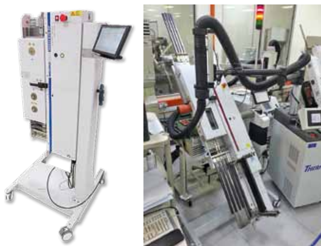
Рис. 14. Хендлер MH250 EVO: а – внешний вид; б – в рабочем состоянии в комплекте с Thermostream
