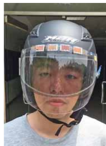
Рис. 5. Прикладное применение органической фотовольтаики: визор мотошлема, изменяющий степень затемнения в зависимости от яркости света. Предоставлено MCUT
