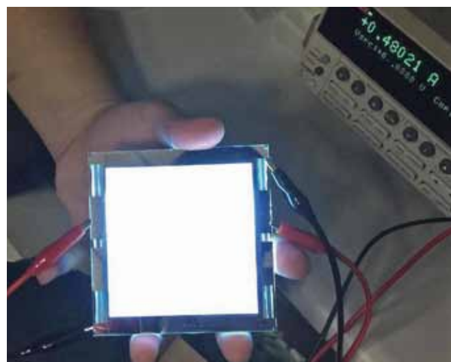
Рис. 3. Осветительная OLED-ячейка, обладающая равномерным излучением по всей площади. Предоставлено MCUT
