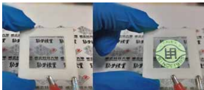
Рис. 2. OLED-дисплей со степенью прозрачности более 80%, соотношением эмиссии верхнего и нижнего слоев 1:1 и внешней квантовой эффективностью выше 20%. Предоставлено MCUT (Ming Chi University of Technology)
