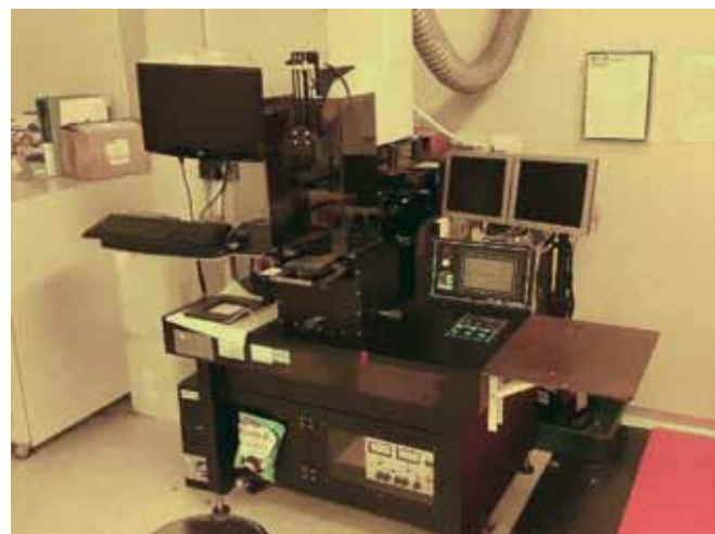
Рис. 7. Установка совмещения и экспонирования на участке фотолитографии
