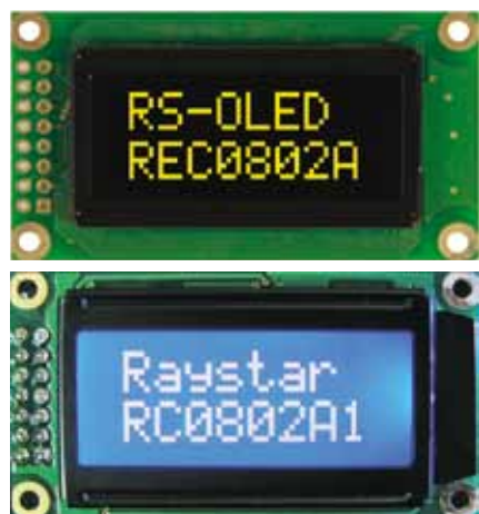
Рис. 3. Сравнение модулей REC000802A (OLED) и RC0802A1 (STN)
