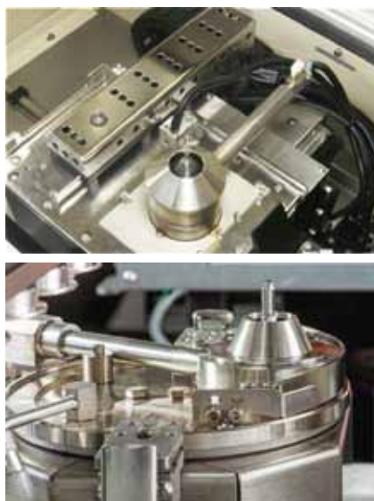
Рис. 5. Типы паяльных модулей: сверху – классический механический модуль; снизу – модуль с электромагнитным приводом
