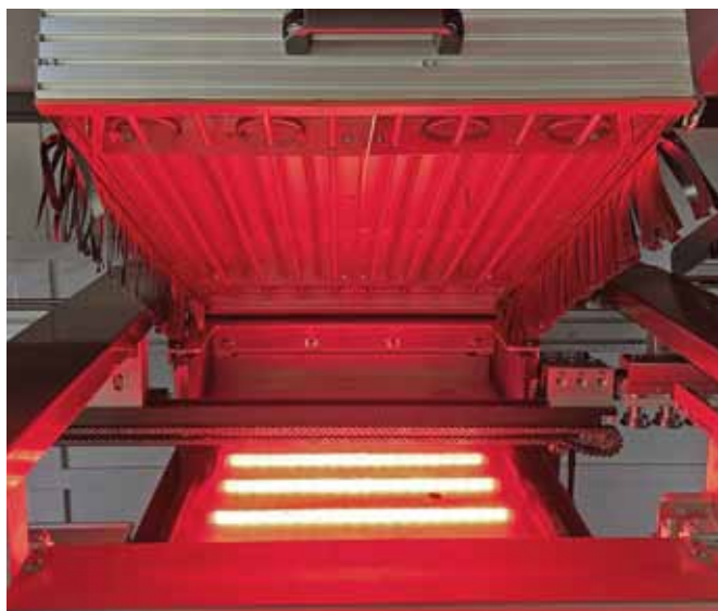
Рис. 4. Предварительный прогрев платы в системах SEL-31/32, SEL-31D/32D
