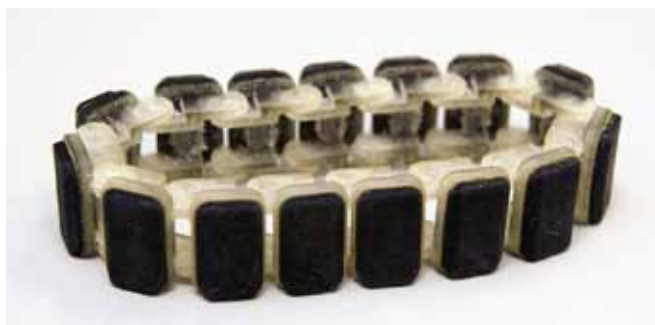
Рис. 1. Изделие, изготовленное из двух материалов на 3D-принтере Objet260 Connex
