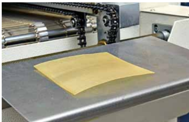
Рис. 2. Образец диэлектрического основания, изготовленный на 3D-принтере, после воздействия температуры
