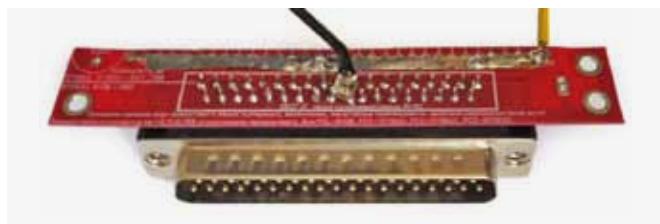
Рис. 1. Внешний вид ДПП2. 32 канала соединены между собой, 4 GND соединены между собой. EXT_TRG не подключен ни к одной из групп
