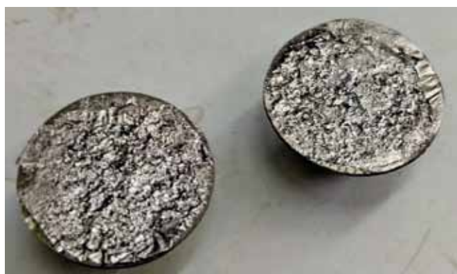
Рис. 11. Разрушение образца по слоям пирографита толщиной 70 мкм
