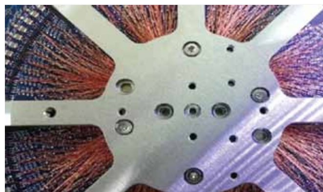
Рис. 10. Зондовая плата с вертикальными зондами с переходником, распаянным проводом
