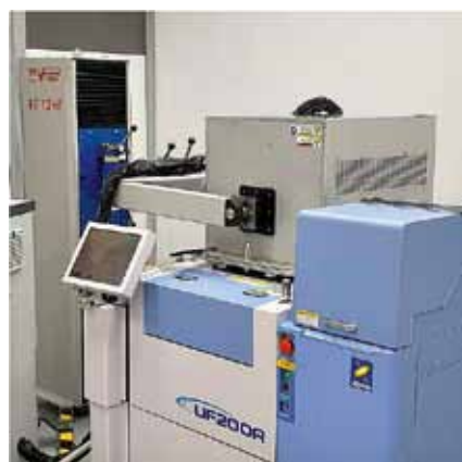
Рис. 2. Оборудование для зондового тестирования
