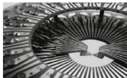
Рис. 4. Зондовая карта с низкими утечками системы параметрического тестирования Keithley серии S600
