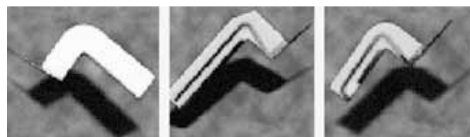
Рис. 5. Типы керамических лезвий (слева направо): стандартное, микрополосковое, радиальное микрополосковое
