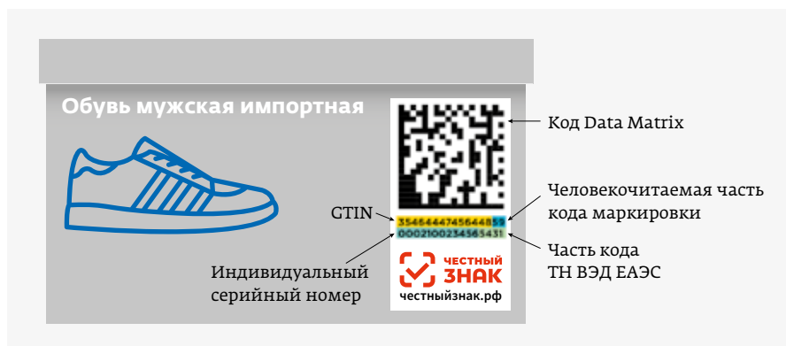
Рис. 10. Схема маркировки Data Matrix системы «Честный ЗНАК»
