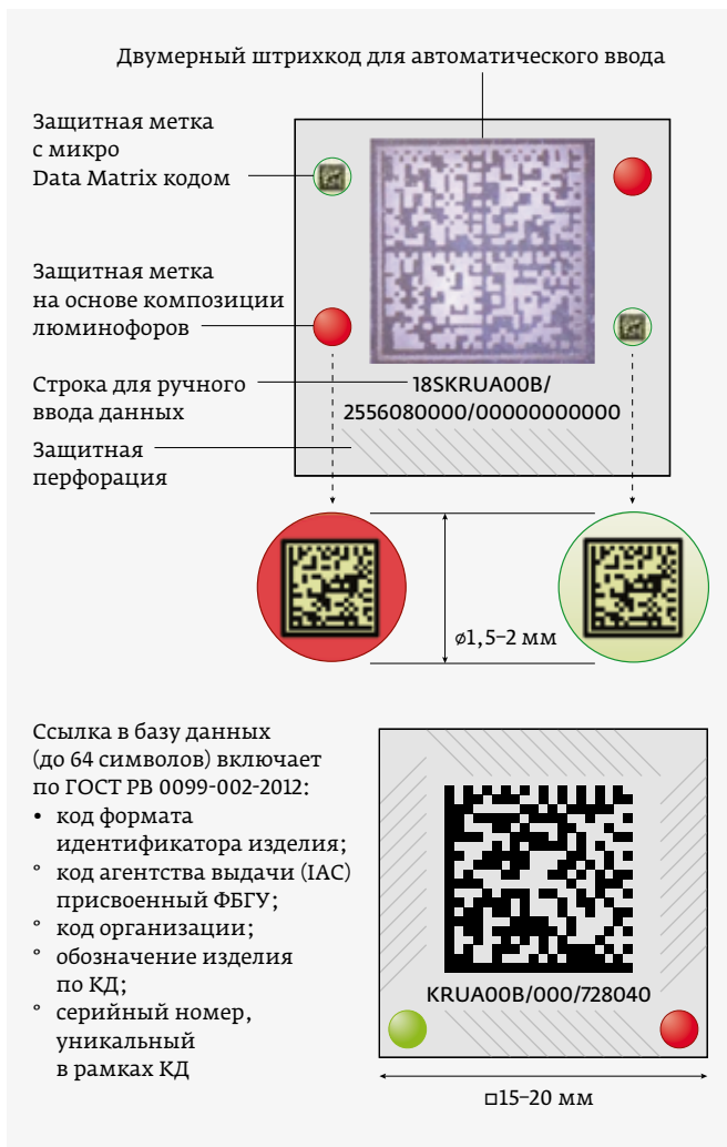
Рис. 24. Пример маркировки с комплексной кодировкой при использовании люминофоров
