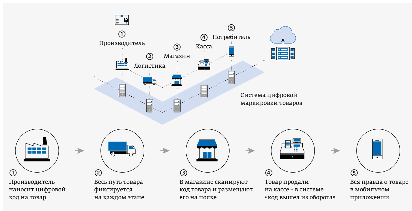
Рис. 1. Поэтапная схема функционирования системы «Честный ЗНАК»
