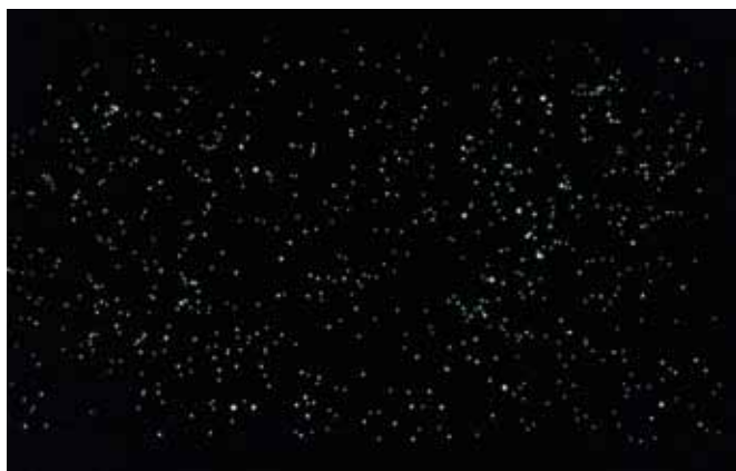
Рис. 23. Пример люминесцентной маркировки в виде «звездного неба»
