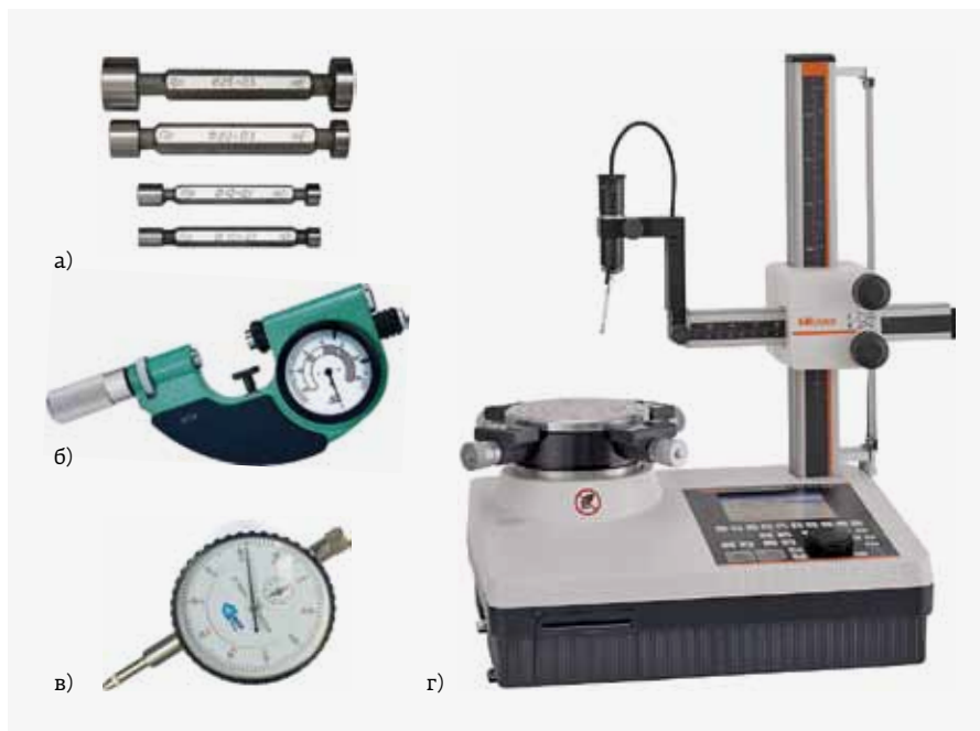
Рис. 1. Способы выявления дефектов формообразования: а – калибрами, б – микрометром-поссаметром, в – индикатором часового типа, г – кругломером
