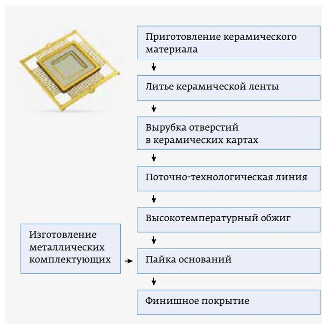
Рис. 1. Технологический процесс изготовления МКК
