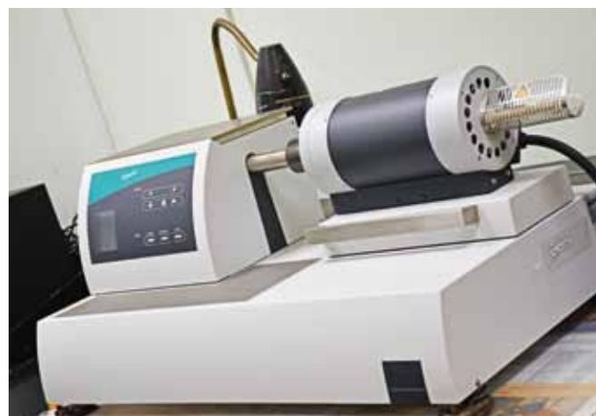
Рис. 3. Высокотемпературный дилатометр
