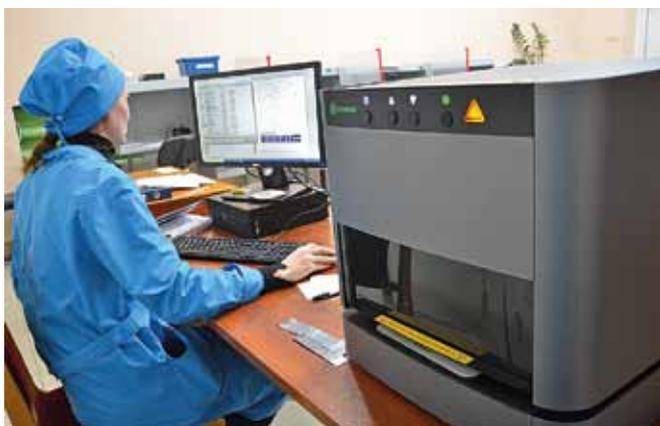
Рис. 5. Рентгенофлуоресцентный анализатор
