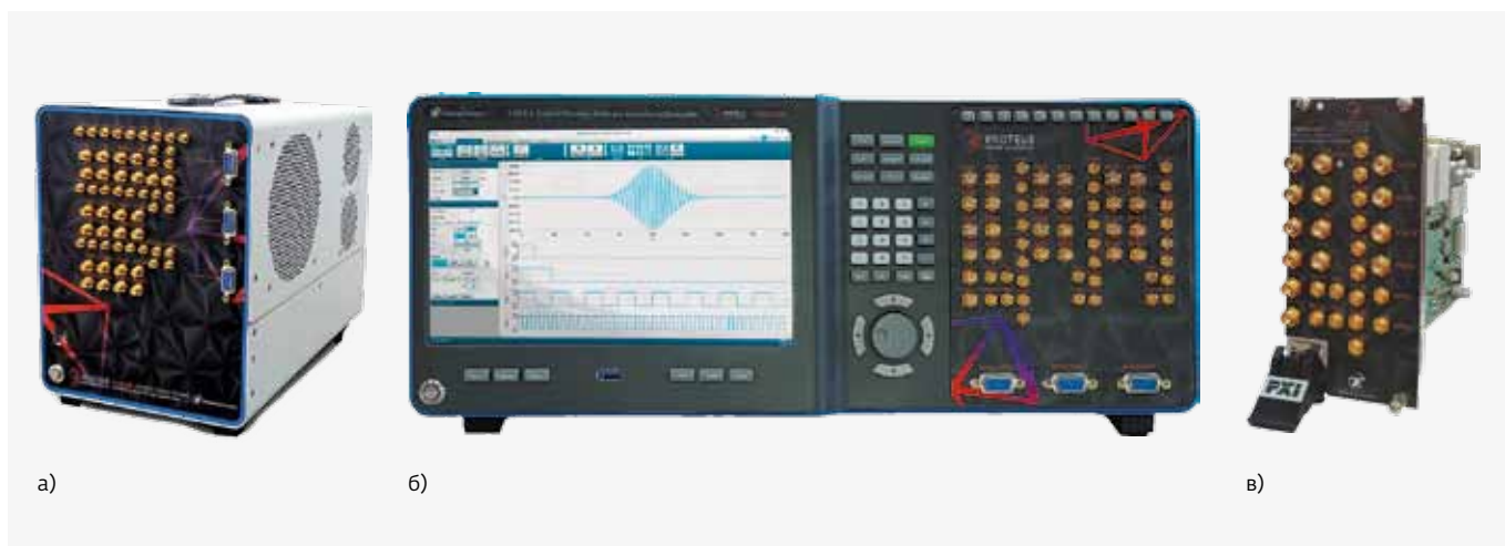
Рис. 13. Приборы серии Proteus AWT компании Tabor Electronics: а – портативный; б – настольный; в – модуль PXI
