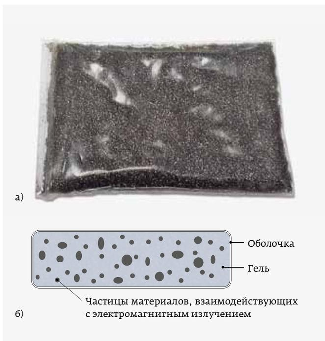
**Рис. 5.** Образец ПЭВ на основе геля: а – внешний вид; б – структура
