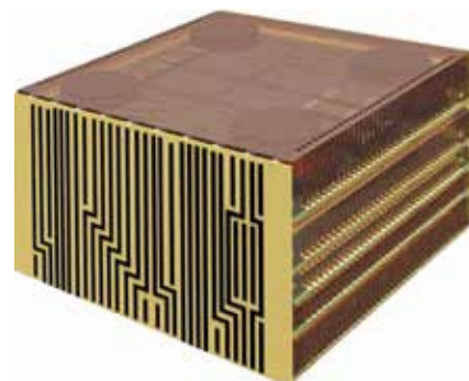
Модель многослойной 3D-микросистемы с торцевой коммутацией
