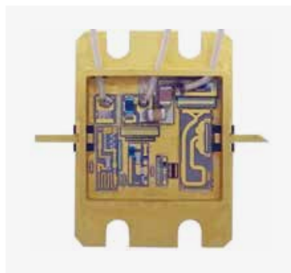
Рис. 7. СВЧ МИС 30-Вт усилителя мощности диапазона 2,9–6,0 ГГц
