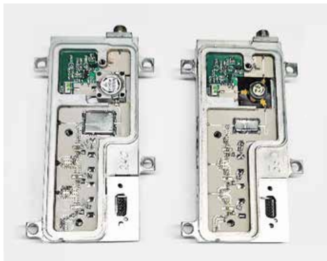
Рис. 5. Конструктивно унифицированные модули 2,4- и 5,8-ГГц модема системы связи с OFDM-сигналом
