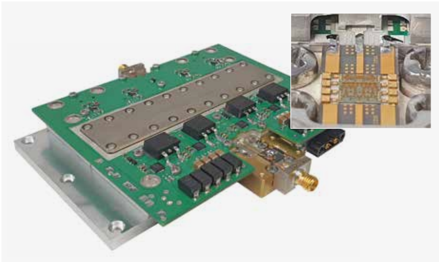
Рис. 10. Внешний вид усилителя без корпуса и GaN МИС выходного каскада
