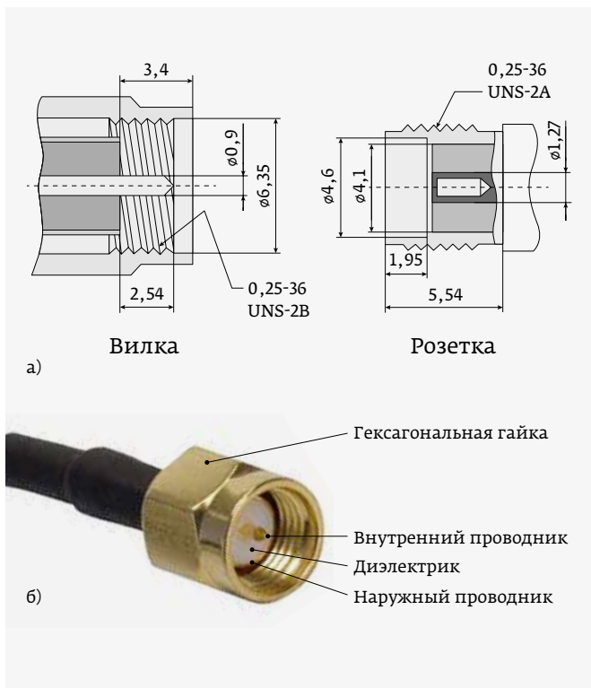
Рис. 7. Интерфейс вилки и розетки соединителя SMA (а), конструкция вилки (б)
