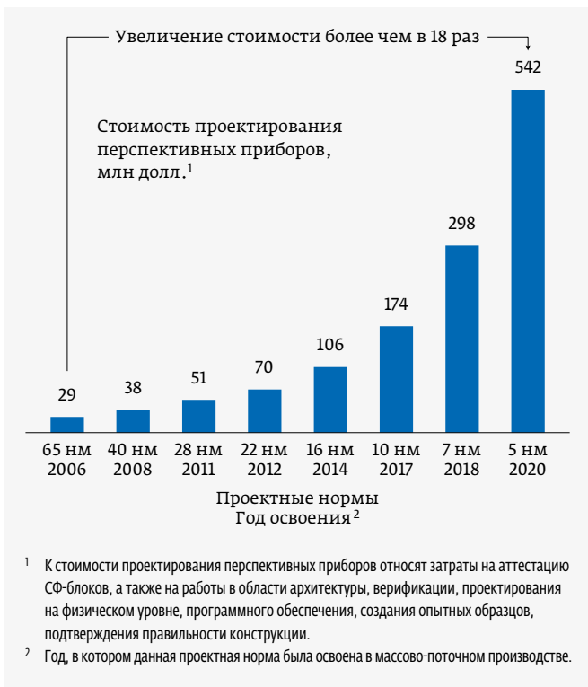
Рис. 2. Рост стоимости проектирования по мере перехода на меньшие проектные нормы
