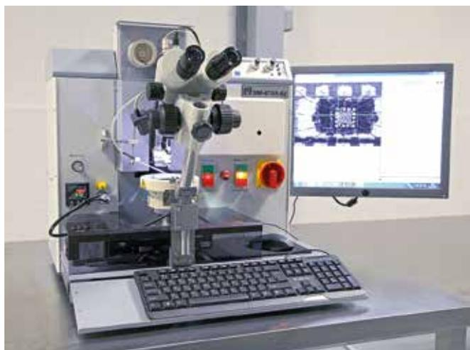
**Рис. 9.** Автоматическая установка термовзвучковой микросварки ЭМ-6705-02 производства ОАО «Планар-СО» научно-производственного холдинга точного машиностроения «Планар»
