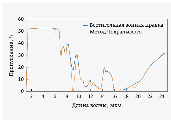
Рис. 3. Спектр пропускания монокристаллического кремния
