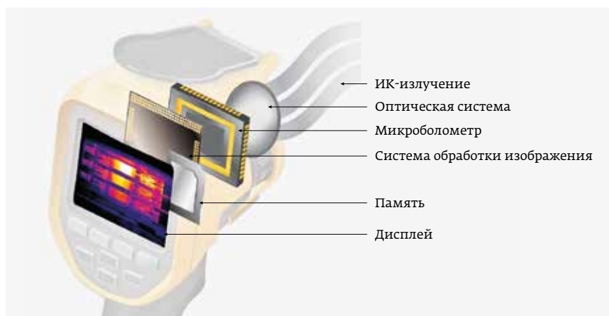
Рис. 1. Устройство тепловизора
