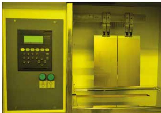
Рис. 1. Заготовки металла с фоторезистом, нанесенным методом окунания
