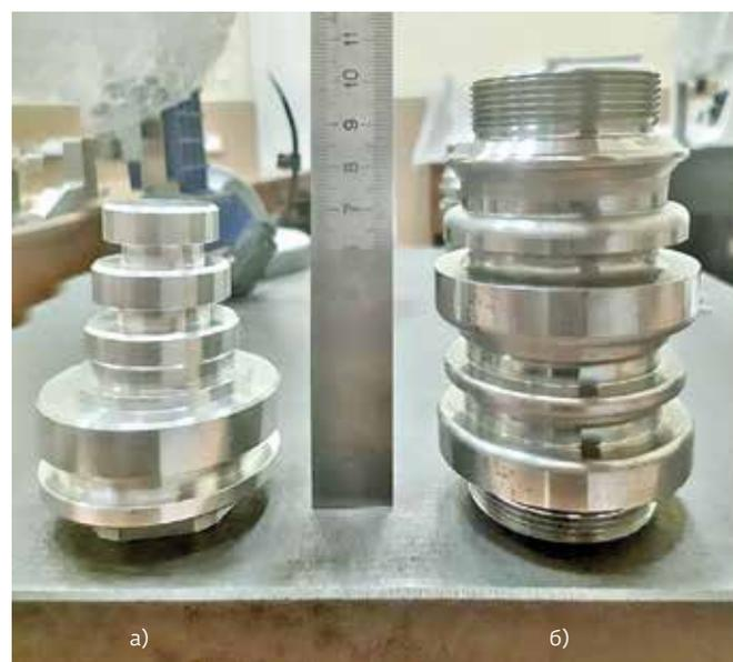
Рис. 2. Исследуемые детали: а – деталь массой 216,65 г (сплав Д16Т) и б – массой 732,6 г (марка стали Ст45)
