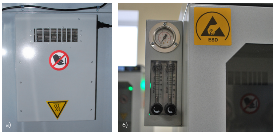
Рис. 5. Опциональные блоки шкафов линейки SDB: а – блок с нагревательным элементом для поддержания стабильной температуры внутри шкафа; б – блок контроля и управления функцией подачи инертного газа
