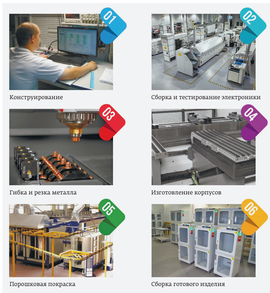
Рис. 6. На заводе ООО «Совтест АТЕ» реализован полный цикл производства шкафов сухого хранения
